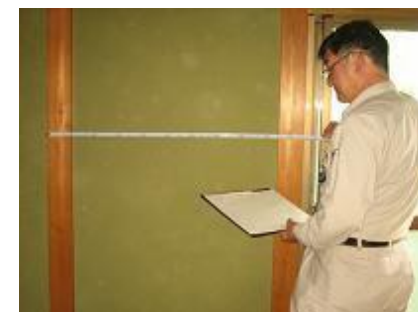
柱・モジュール 寸法調査
